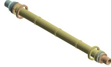
Figure 4. FINITE ELEMENT MODEL OF SHAFT-SLEEVE SYSTEM
